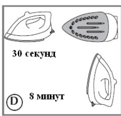
Функция автоматического выключения утюга действует следующим образом: Оставленный на подошве или опрокинутый на бок утюг, который нагрелся до определенной температуры, но не эксплуатируется, автоматически отключится через 30 секунд. Если утюг не эксплуатируется и находится на пяте-опоре в вертикальном положении - режим автоматического отключения сработает через 8 минут (рис. D). Автоматическое отключение утюга сопровождается звуковым сигналом.
